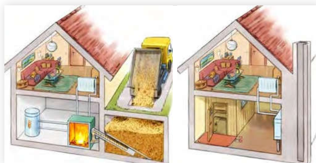
Hackschnitzelheizung mit Lagerraum und Rührwerkaustragung (li.), bei Platzmangel bietet sich der Anschluss ans Nahwärmenetz an (re.).
