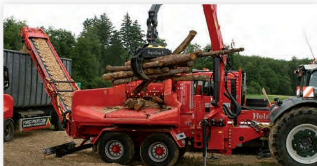
Trommelhacker mit großem Einzugsstisch und Förderbandaustragung
